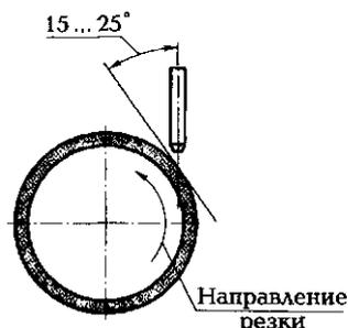
применять для выполнения прямолинейных и криволинейных резов с большим радиусом кривизны.
