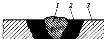
ки ЗТВ подвергаются нагреву от температуры, близкой к температуре плавления (вблизи границы сварочной ванны), до температуры начала структурных превращений (около границы основного металла, не подвергшегося нагреву).
